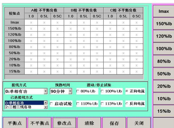
如果需要修改对应的平衡点、分元点、不平衡点的校验点，则选择所需要修改的校验点对应的快捷键按钮，此时在对应的按钮上会出现一个空白框，输入所需的校验点值，再次按“ENTER”确定。（注意：校验点重复无效，如果输入值为 0 则默认为是 IMAX。），再次按“修改点”按钮，则又回到上个界面所示。
