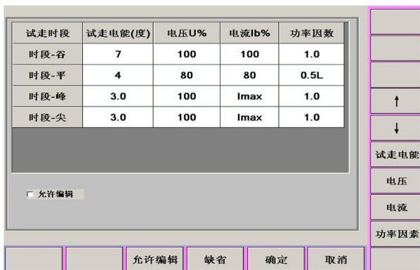
用于检验分时表各时段分时电量与总电量之间的差值误差,走字点设置可参考需量点的设置。
